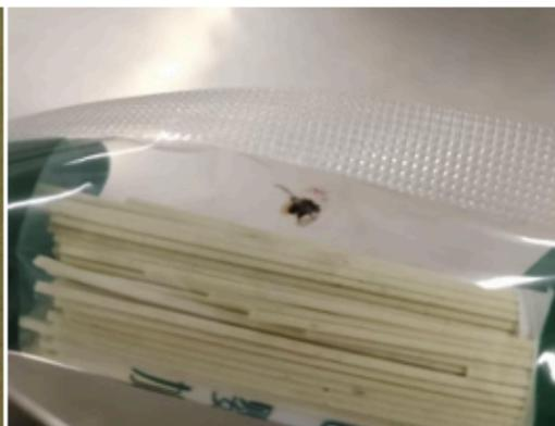
违反《食品包装用符合膜、袋技术标准》条款：2.1 食品用复合包装膜表1外观质量，“无划伤、烫伤、穿孔、粘连、异物、分层、脏污”。
